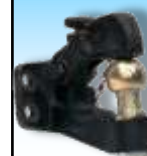
Crochet fixe PERCAGE 4 trous Ø 17 40 x 90 mm Pour rotule Ø 50 ou anneau 42 x 68 - 42 x 76 Traction pour un P.T.C de 3,5 T Poids : 4,9 Kg
