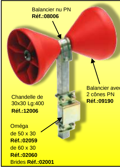
Ensemble cônes sur balancier avec chandelle, brides et oméga
