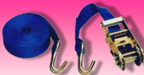
Sangle complète : Longueur : 7 m - Largeur : 35mm Force : 2500 Kg
